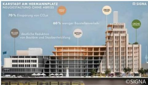
Die Infografik zeigt den Umbau des Karstadt am Hermannplatz. Sie enthält folgende Informationen: 70 % Einsparung von CO<sub>2</sub>e, 60 % weniger Baustellenverkehr, deutliche Reduktion von Baustoff- und Staubentwicklung. Die Grafik ist mit den Begriffen REUSE, WOOD, BRICK, CONCRETE und GREEN beschriftet. ©SIGNA
