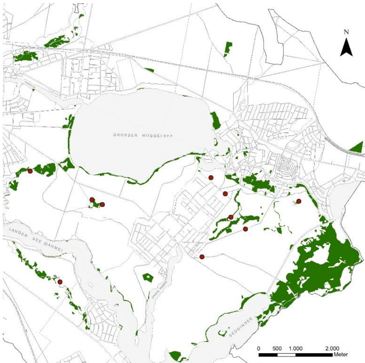
Abb. 29: Lage der verwendeten Grundwassermessstellen für die Beurteilung der hydrogeologischen Auswirkungen auf grundwasserabhängige Landökosysteme im Bereich Friedrichshagen bis Seddinsee (GWMS als rote Punkte, gwaLÖs als grüne Flächen)
