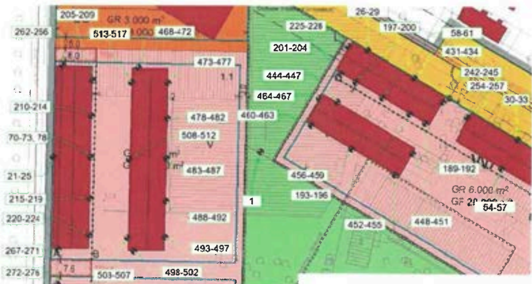
Abb. 11 Ausschnitt der Immissionspunkte aus der schalltechnischen Untersuchung, Andreas Wilke Ingenieurbüro, Juli 2022, alle Immissionspunkte siehe auch Anhang, Anlage 5
