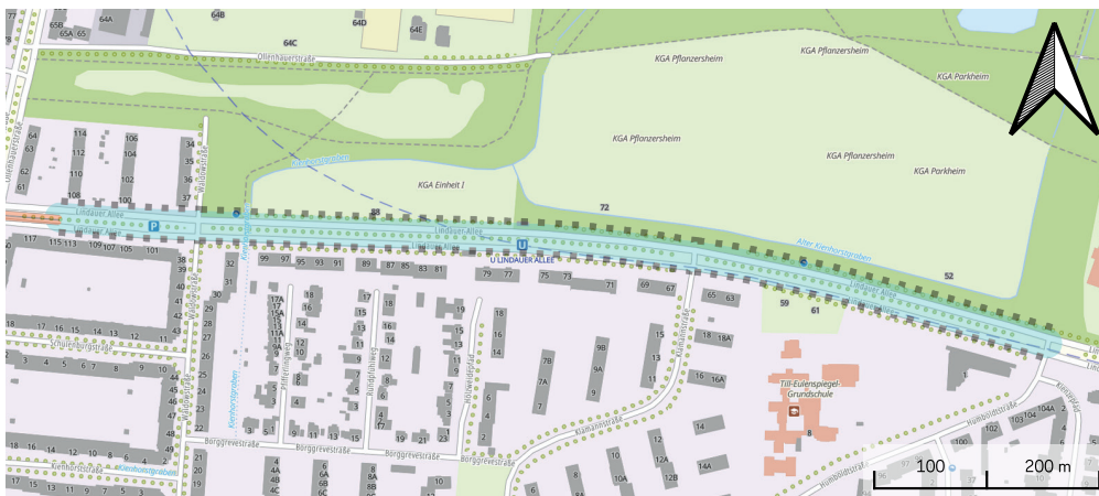
Abbildung 12: Lärmarme Fahrbahnoberfläche auf der Lindauer Allee (türkise Markierung)
