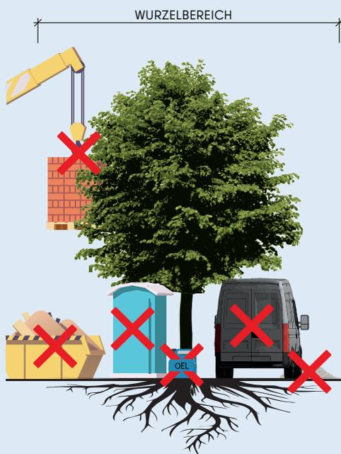
Im Wurzelbereich ist schonend in Handarbeit oder durch Absaugen zu arbeiten. Der Mindestabstand zum Wurzelanlauf muss mindestens 2,50 Meter betragen.
