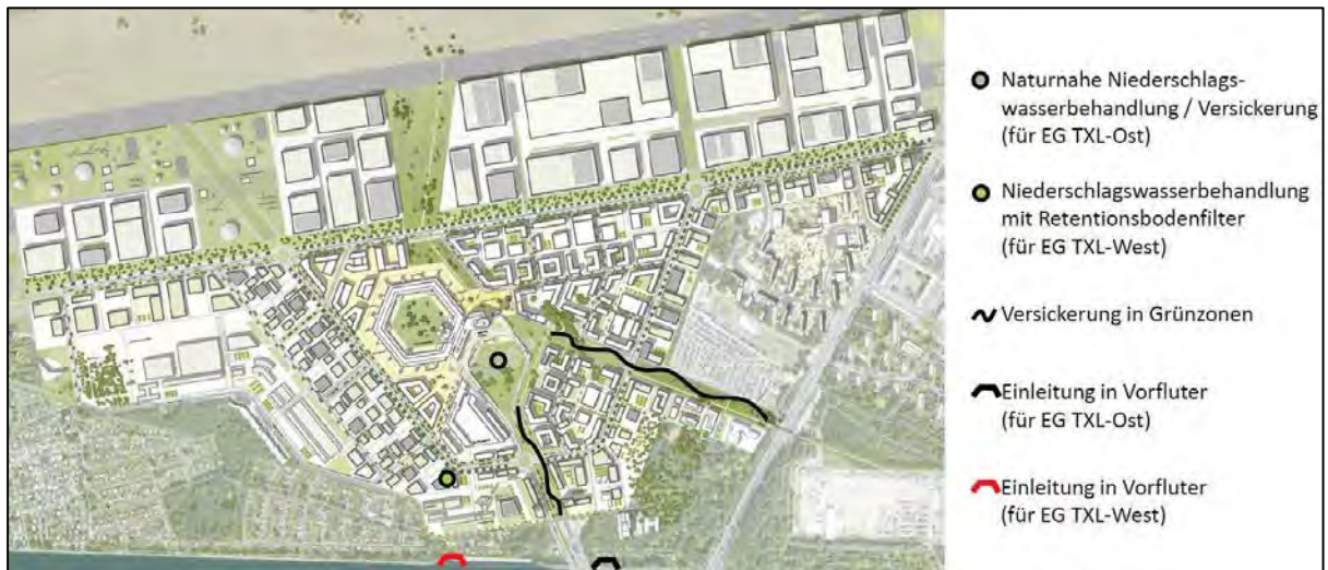
Abb. II.14: Regenwasserkonzept der UTR (TP 2015)
