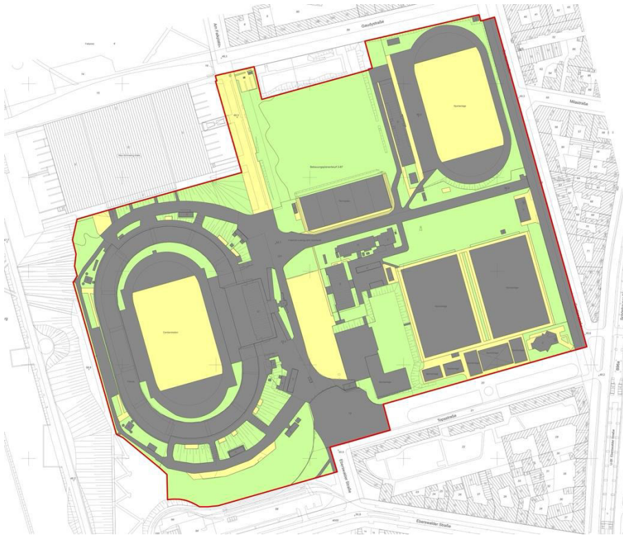
Abbildung 8: Flächenversiegelung im Plangebiet im Bestand
